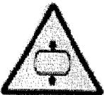
**Recipienti in pressione. Pericolo di fuoriuscita di liquidi in pressione.** applicato sui recipienti e sui cilindri idraulici che rimangono in pressione .
